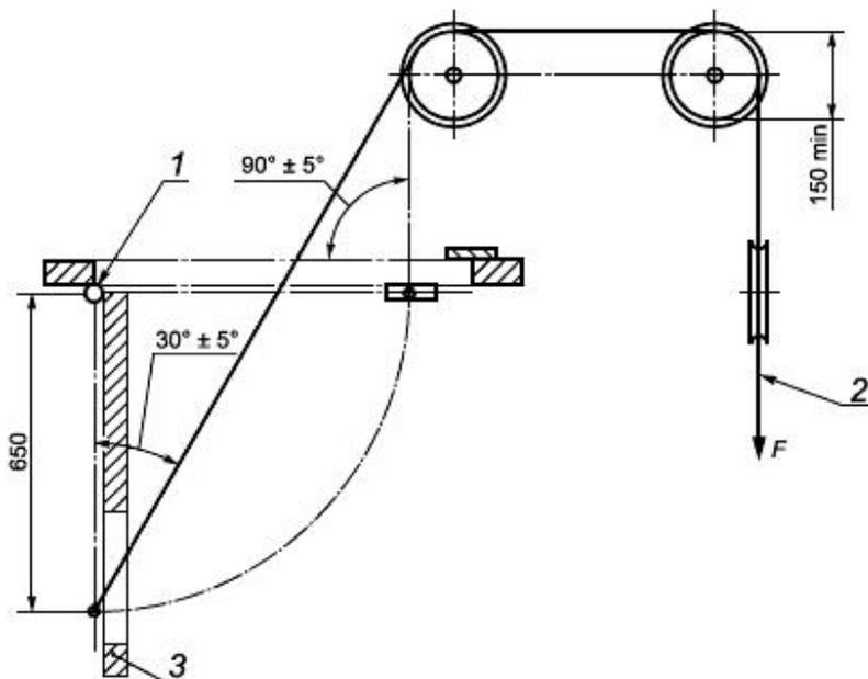
1 - дверная поворотная опора; 2 - трос к падающим грузам; 3 - испытательная дверь с доводчиком, открытая на 90°
