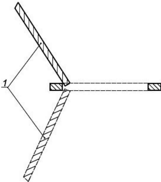
1 - возможность открывания на угол  $120^\circ$  в обоих направлениях
