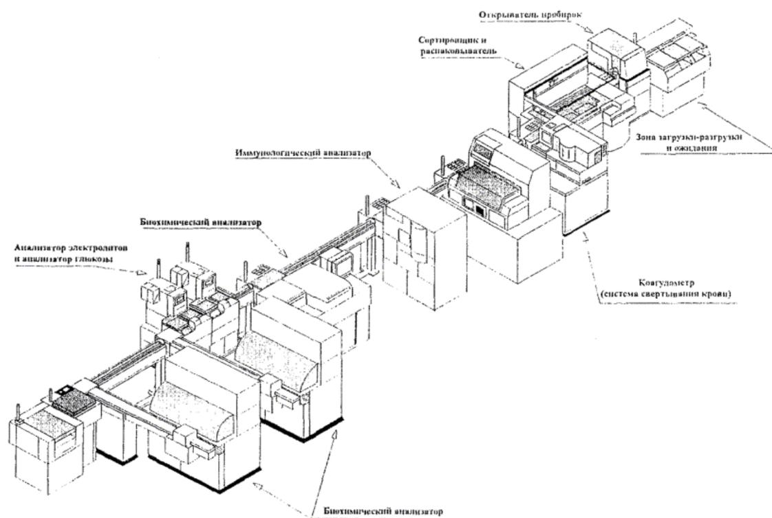
Рис. 1.1 Вариант компоновки оборудования лабораторной для биохимических, гормональных, иммунологических исследований и для коагулологии
