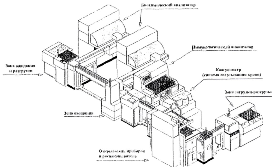
Рис. 1.2. Вариант компоновки оборудования лаборантской для биохимических, гормональных, иммунологических исследований и для коагулологии
